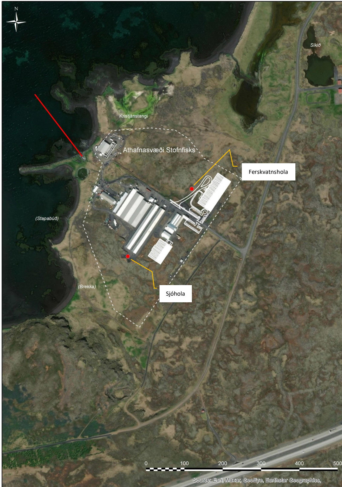
Mynd 4.2 Yfirlitsmynd sem sýnir fyrirhugaða seiðeldisstöð, í NA horni lóðar, og nýtt hrognahús, sunnan við núverandi hrognahús, og afstöðu húsanna til annarra mannvirkja á lóð Stofnfisks. Væntanlegar staðsetningar á nýjum borholum fyrir jarðsjó og ferskvatn eru merktar með rauðum depli. Áætluð lega frárennslislagnar í sjó er auðkennd með rauðri línu.
